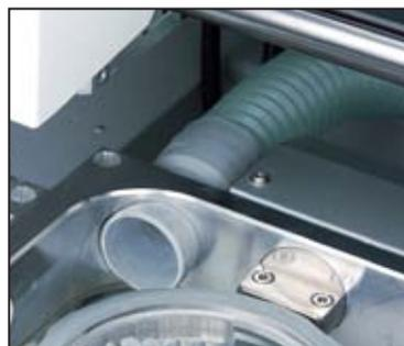
difíciles de mecanizar, tales como PMMA (polimetilmetacrilato) o zirconio. La bandeja incorporada de recolección de polvo puede también ser fácilmente conectada a cualquier sistema de aspirado para laboratorio, manteniendo el área de corte limpia y libre de residuos.
